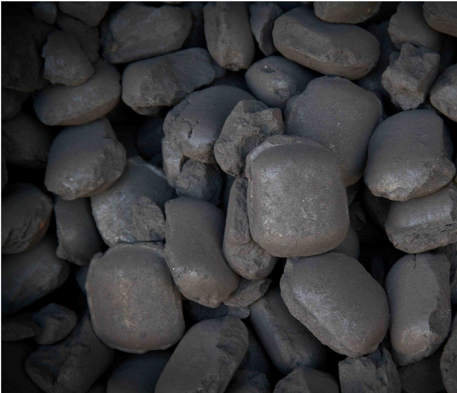
Pellets de pig iron (fer bas de casse, substitut au minerai de fer - ph SD )
